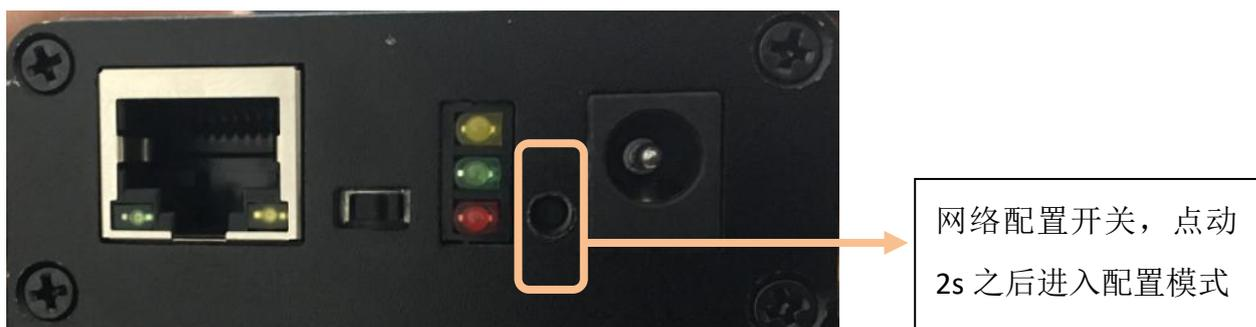
图 2 点动 RESET 开关，进入配置状态
